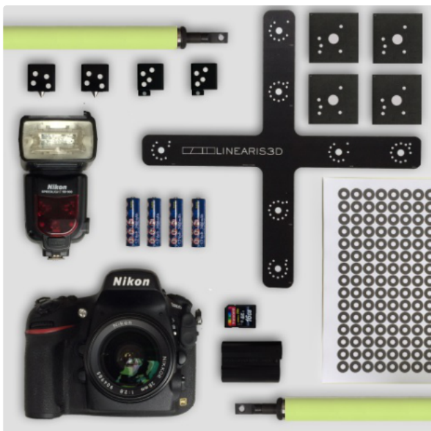
Abbildung 5: Elemente des Photogrammetrie-Systems, u.a. Kamera, Blitz, Maßstab, Marken, Startkreuz.
